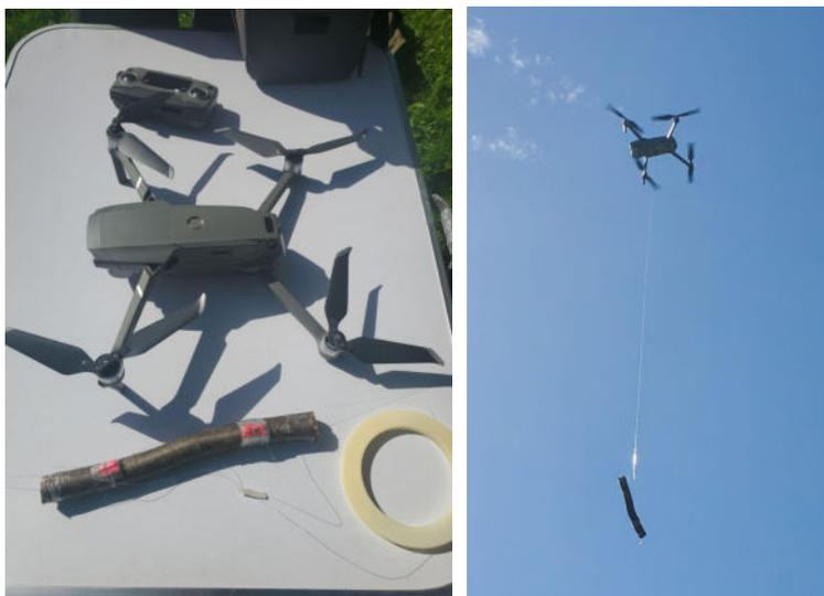
↖ Un bâton sur lequel sont attachées 4 balises activées (ici 2 lors d'un premier test) est attaché au drone par un fin fil de nylon, puis ↗ le drone monte à différents paliers d'altitude fixe
