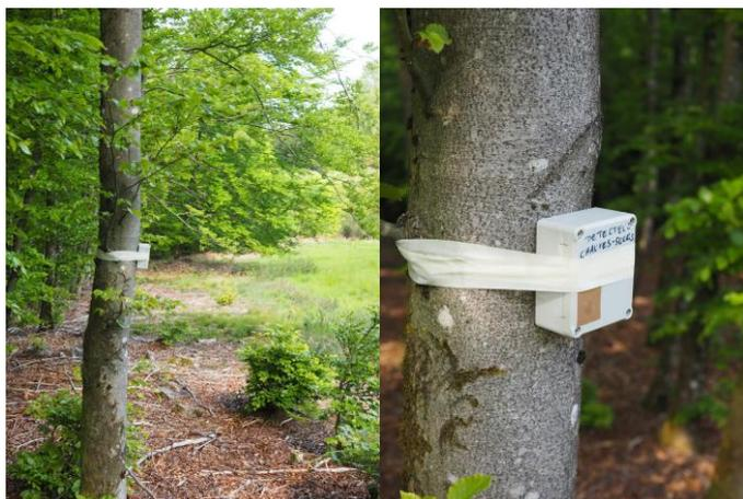
*Détecteur à ultrasons utilisé pour les inventaires de chauves-souris installé dans la lisière sur le site d'Oppagne.*
