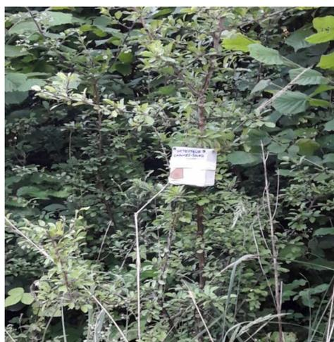
Les détecteurs d'ultrasons sont protégés par une boîte étanche et accrochés à un support (arbre, clôture, ...) en bordure de la zone inventoriée. Le micro (flèche) est toujours dirigé vers le couloir, perpendiculairement à l'axe.
